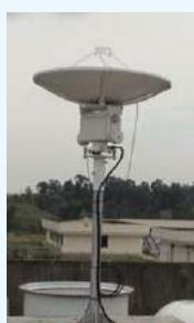
Ground Satellite Receiver berguna untuk pengamatan cuaca jarak jauh dengan cakupan area yang luas. Jenis Satelit yang mengirimkan sinyal ke Ground Satellite Receiver ada 2 macam yaitu Geostasioner (Satelit MTSAT) dan Polar Orbital (Satelit NOAA).
